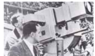
Cámara con iconoscopio, provista de teleobjetivo, que se utilizó para captar algunos deportes de los Juegos Olímpicos de Berlín en 1936. Maneja la cámara el ingeniero Dr. Bruch que años más tarde inventaría el sistema PAL de televisión en color
