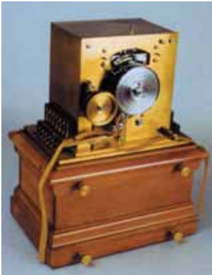
Traductor Baudot. El receptor del sistema Baudot se denomina traductor y contiene cinco electroimanes que se accionan por las corrientes recibidas para cada letra o signo, y hacen que en el momento preciso se proyecte la cinta de papel contra las ruedas de tipos entintadas, imprimiéndose el signo correspondiente
