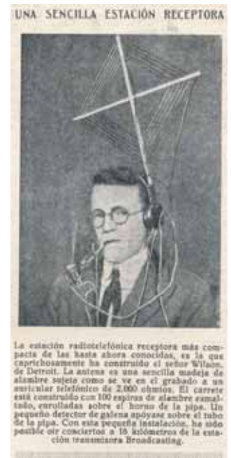
La estación radiotelegráfica receptora más compacta de las hasta ahora conocidas, es la que caprichosamente ha construido el señor William de Detroit. La antena es una sencilla madeja de alambre sujeta como se ve en el grabado a un auxiliar telefónico de 2.000 ohmios. El carrete está construido con 100 espiras de alambre esmaltado, enrolladas sobre el hornos de la pipa. Un pequeño detector de galena apoyase sobre el tubo de la pipa. Con esta pequeña instalación, ha sido posible oír conciertos a 15 kilómetros de la estación transmisora Broadcasting.
