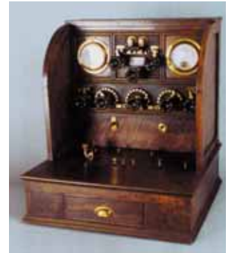
Dúplex de Pérez Santano. El telegrafista español Pérez Santano ideó ya en 1877 un montaje telegráfico que permitía cursar por un solo conductor dos mensajes en sentidos opuestos, haciendo independientes las corrientes de emisión y recepción. Se utilizó tanto para comunicaciones en Morse como para los sistemas rápidos de Hugues y Baudot, incluso en cables submarinos
