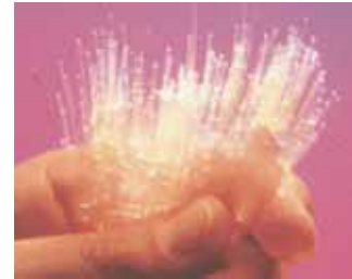
Fibra óptica. La capacidad teórica de transmisión es mayor de 100 Tbps (100 billones de bps.). La velocidad utilizada en la actualidad, en aplicaciones comerciales, es de 2,5-10 Gbps, debido al equipamiento optoelectrónico (transmisores/receptores)
